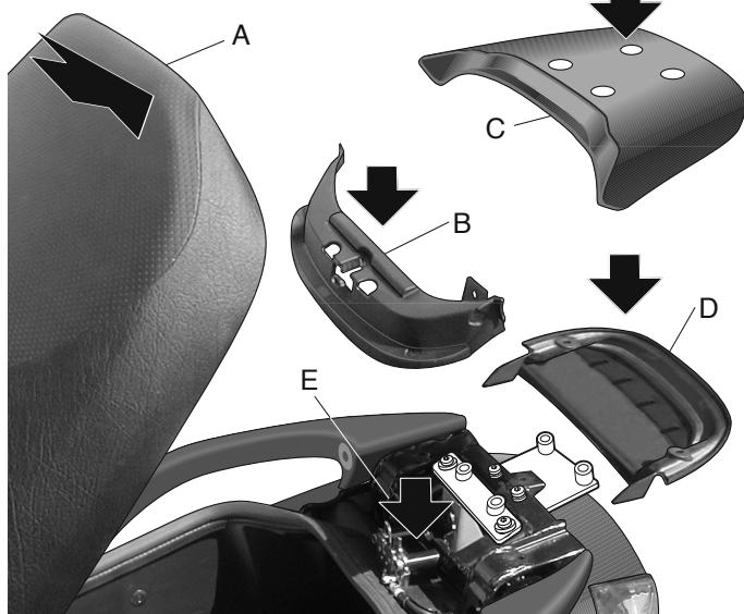
(E) Montar el soporte estructura interior refuerzo (E). Montar el embellecedor interior (B), la tapeta posterior (C) del agarradero y el embellecedor trasero (D). Montar el mecanismo de cierre del asiento. Cerrar el asiento (A).
