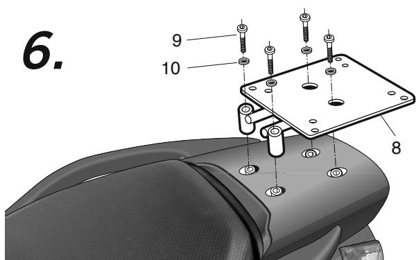
(E) Posicionar la parrilla KIT TOP (8), mediante los tornillos (9) y arandelas (10).
