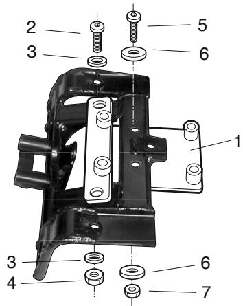
(E) Lo fijaremos en zona delantera mediante los tornillos (2), las arandelas (3) y las tuercas (4). Y en zona trasera mediante los tornillos (5), las arandelas (6) y las tuercas (7).
